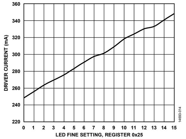
图 17. LED 驱动器电流与 LED 精调设置的关系
