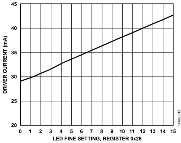
图 16. LED 驱动器电流与 LED 精调设置的关系
