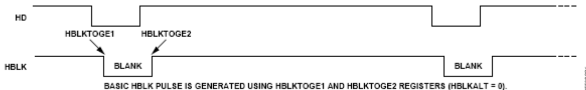
图26. 典型水平消隐(HBLK)脉冲位置
