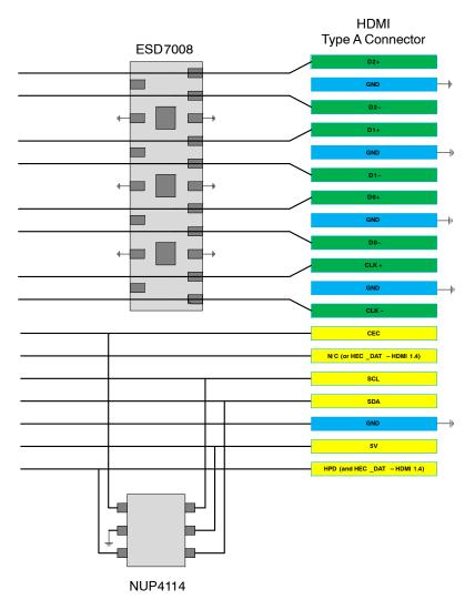
Figure 18. HDMI Layout Diagram
