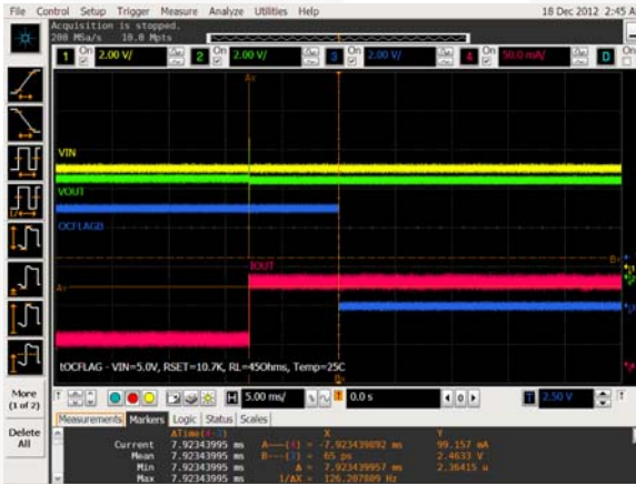
图 8. OC_FLAGB 响应时间 (将 R_{LOAD} 从高电阻切换到低电阻)
