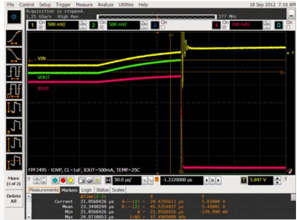
图 7. OVP 响应 (将 V_{OUT} 增加至 OVP 跳变点)
