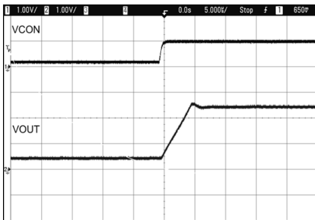
图 25. V_{OUT} 上升跃迁0.5 V至2.5 V、 V_{IN} = 3.7\text{ V}
