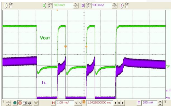
图 30. 过流, 负载增加过去电流限制, FAN53611
