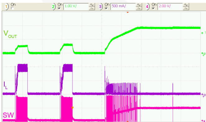
图 37. 过载恢复至轻载, 50\ \mu\text{s/div} 。
