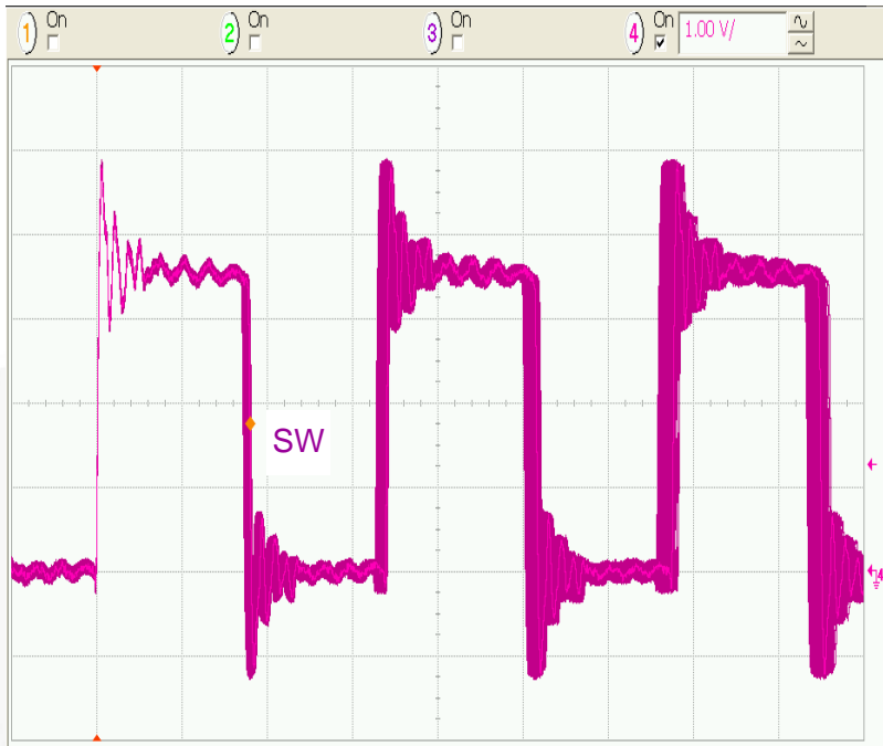
图 39. SW节点抖动 (无限持久性), I_{LOAD} = 200\text{ mA} , 50 ns/div.
