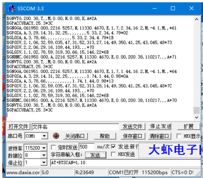
等待 3 分钟都没定位成功，请检查 GPS 天线是否安装正确，GPS 天线是否放置在室外，或者换一个室外空旷的地方测试。
