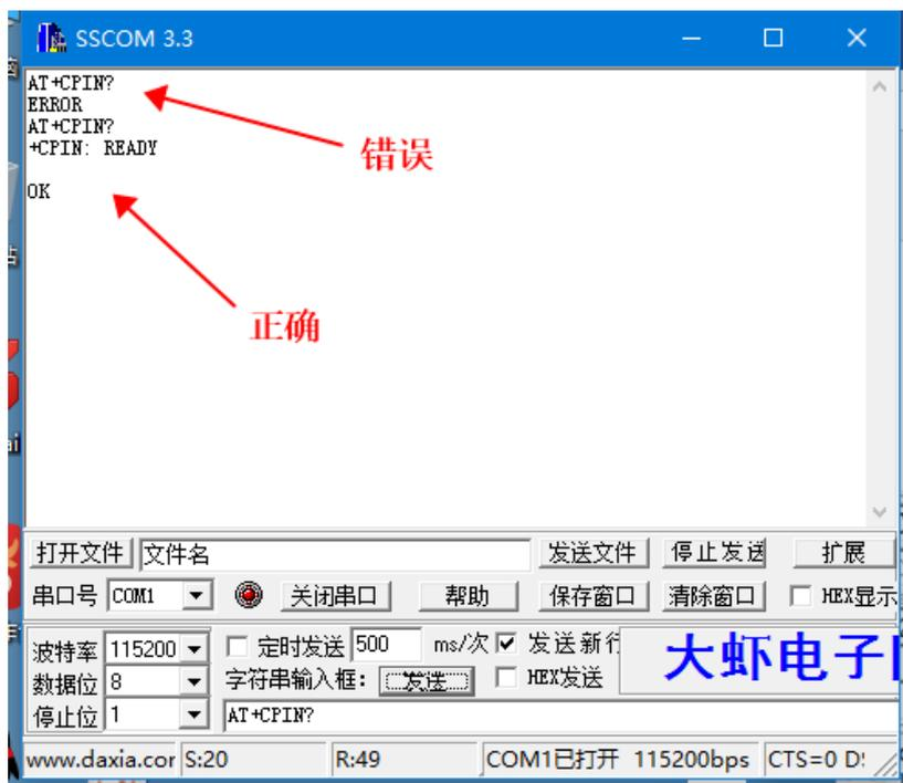
错误时，请检查手机卡安装方向是否和卡座旁边的标识一致，检查手机卡表面是否干净。
