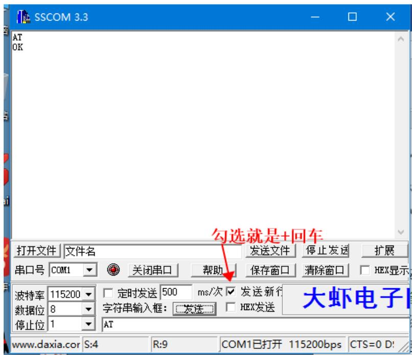
D、确认手机卡时候被识别到,发送“AT+CPIN?+回车”；
