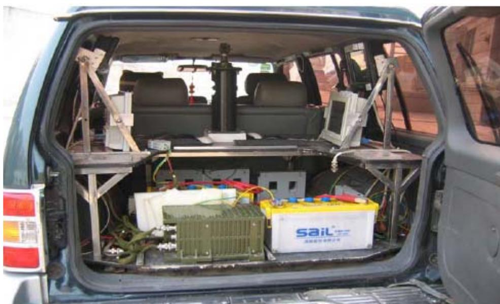
图 6.2 (b) 激光陀螺捷联惯导系统的安装
