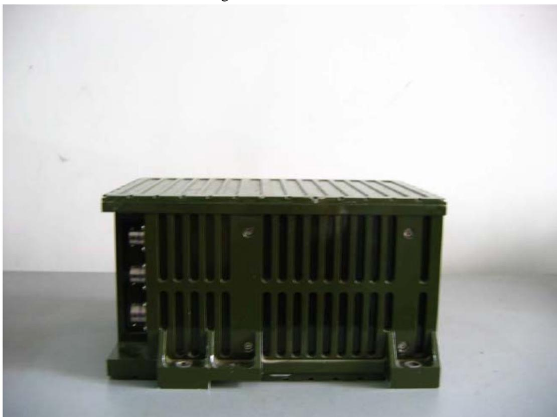
图 6.1 激光陀螺捷联惯导系统
