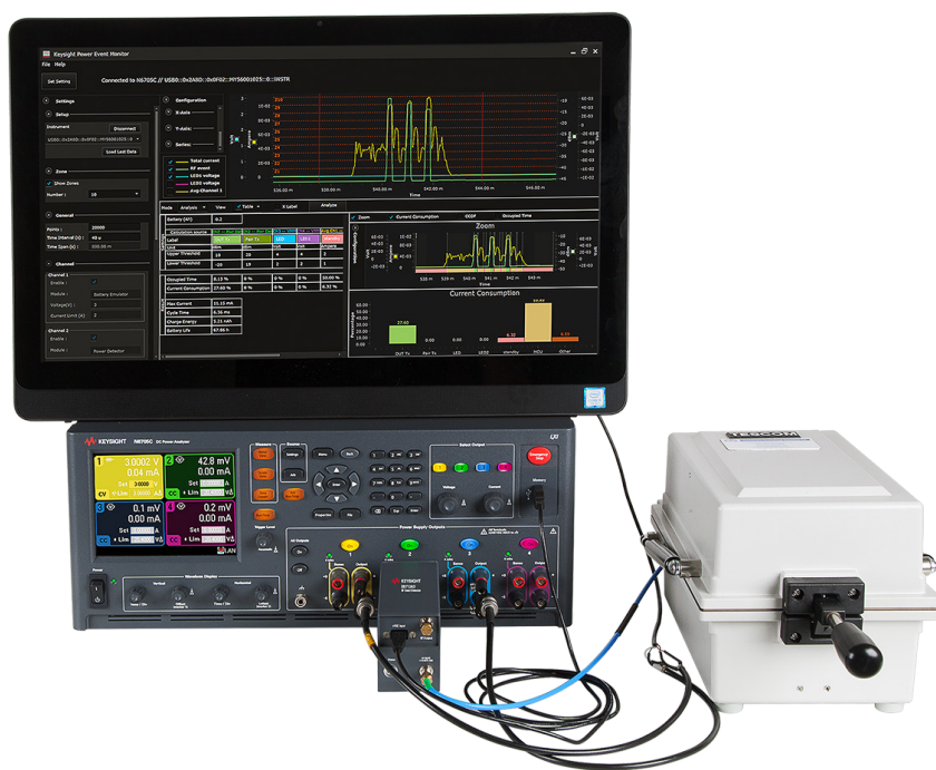
图 1：X8712A 物联网电池寿命优化测试解决方案由 X8712A-DPA 直流电源分析仪、X8712A-SMU 电池消耗分析仪 SMU、X8712AD 射频事件检测器和 KS833A1A 基于事件的功率分析软件组成
