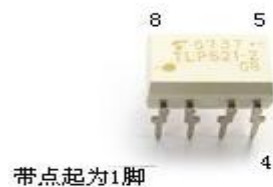
图 2 TLP521-2 光电耦合器引脚排列图
