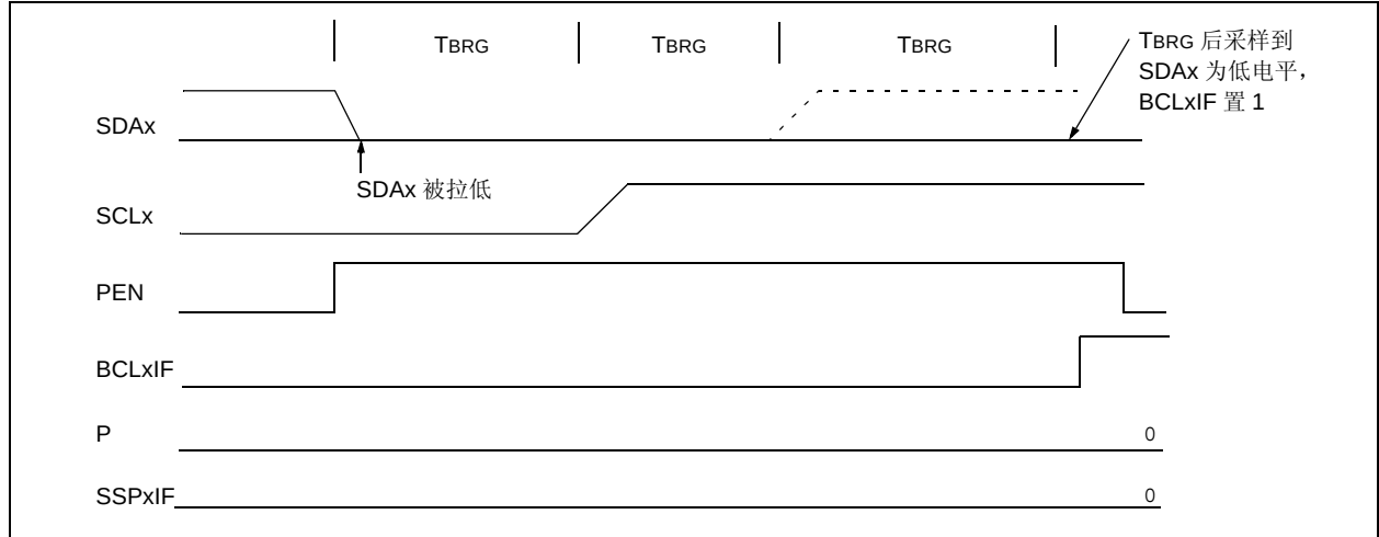
图 21-33: 停止条件期间的总线冲突（情形 1）
