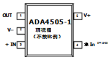
图1. 5 引脚SOT-23 (RJ-5)
