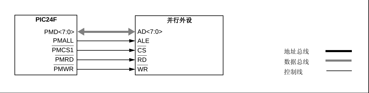
图 18-9: 8 位地址和数据复用的应用示例
