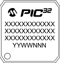
144 引脚 TQFP（16x16x1 mm）
