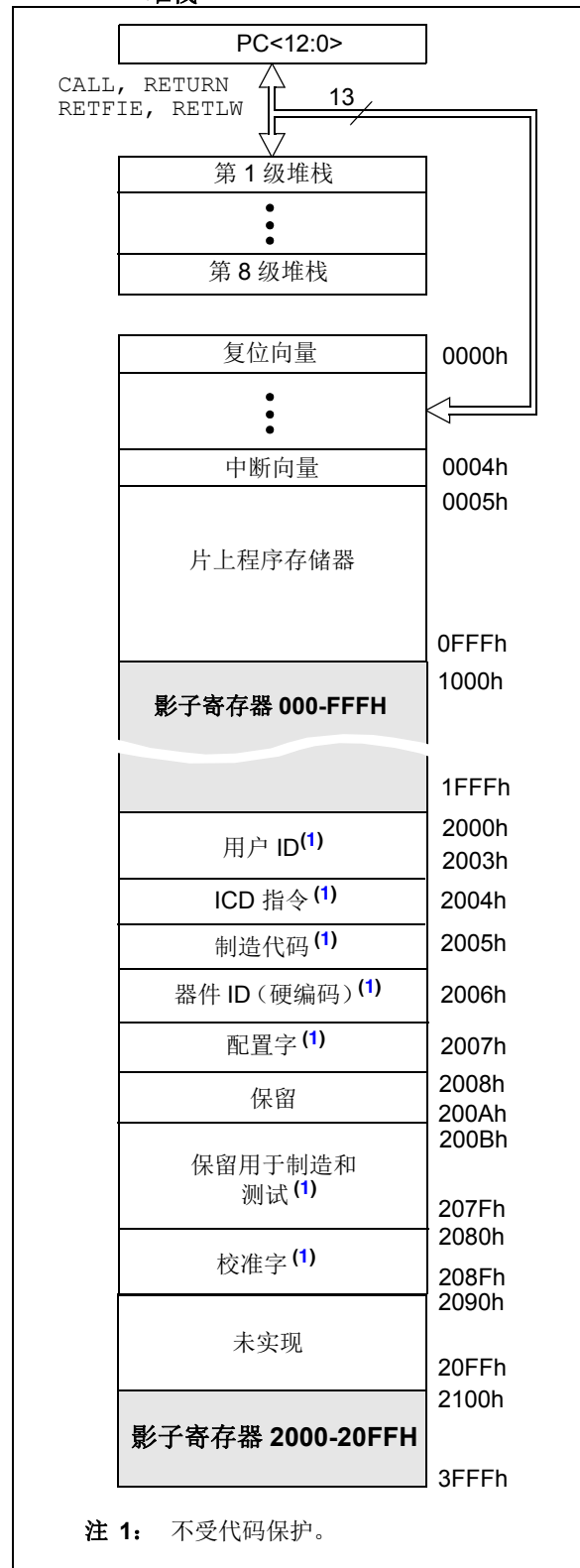
图 11-1： MCP19118/19的程序存储器映射和堆栈
