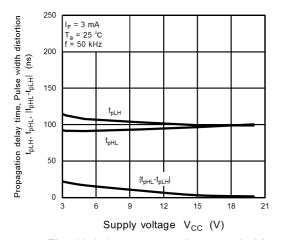
Fig. 12.2.17  $t_{pHL}$ ,  $t_{pHL}$ ,  $t_{pHL}$ - $t_{pLH}$  -  $V_{CC}$
