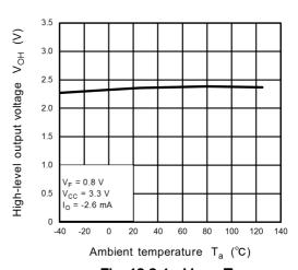
Fig. 12.2.4 V<sub>OH</sub> - T<sub>a</sub>
