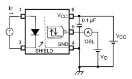
Fig. 12.1.5 I<sub>OSL</sub> Test Circuit
