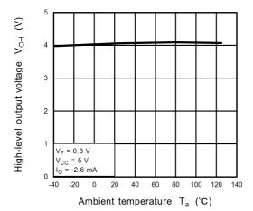
Fig. 12.2.5 V<sub>OH</sub> - T<sub>a</sub>
