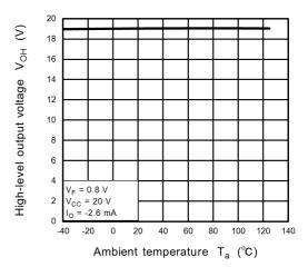
Fig. 12.2.6 V<sub>OH</sub> - T<sub>a</sub>
