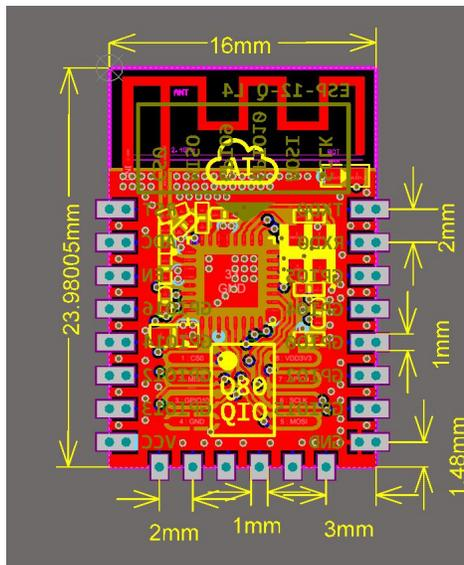
图 4 ESP-12F 模组尺寸平面面图
