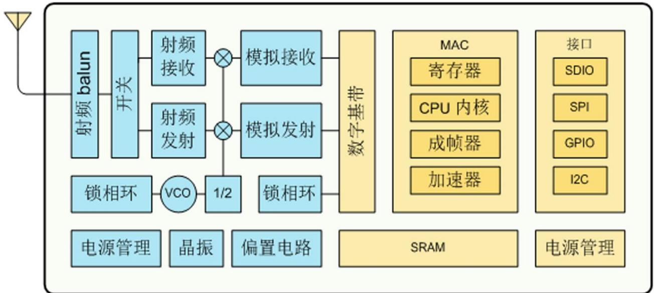
图 1 ESP8266EX 结构图
