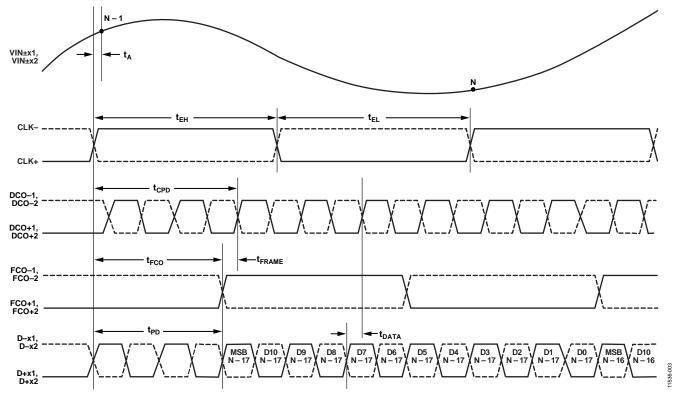
Figure 4. Wordwise DDR, 1× Frame, 12-Bit Output Mode
