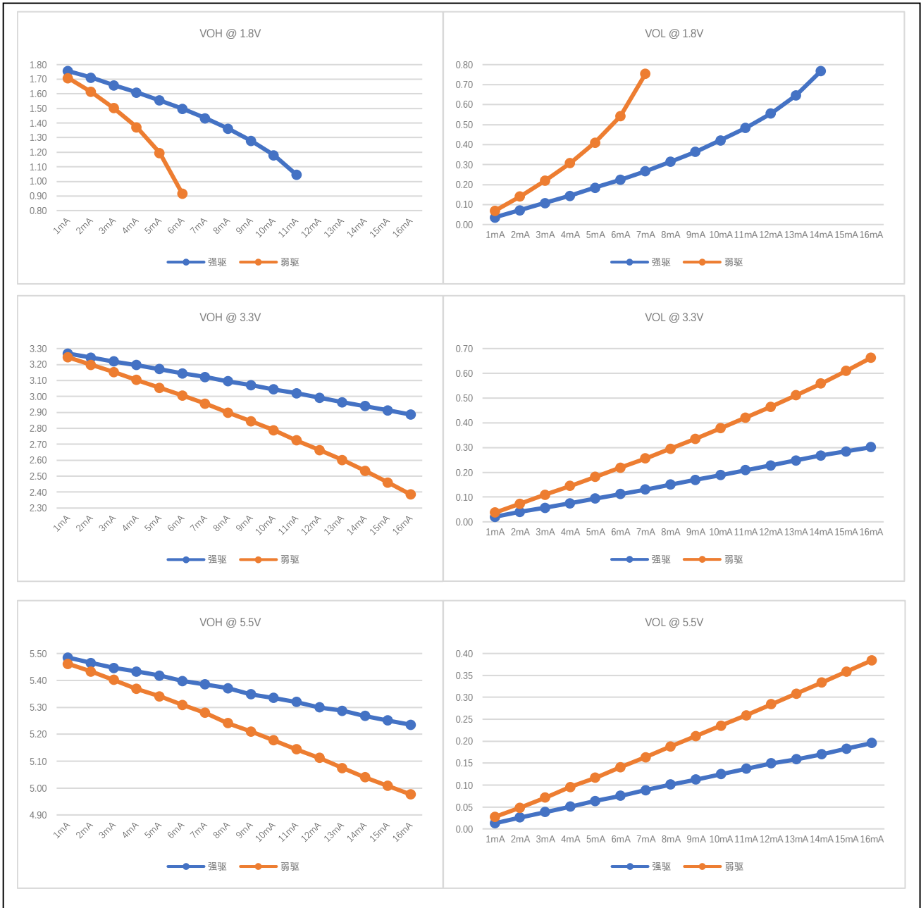
图 36-2 输出端口 VOH/VOL 实测曲线
