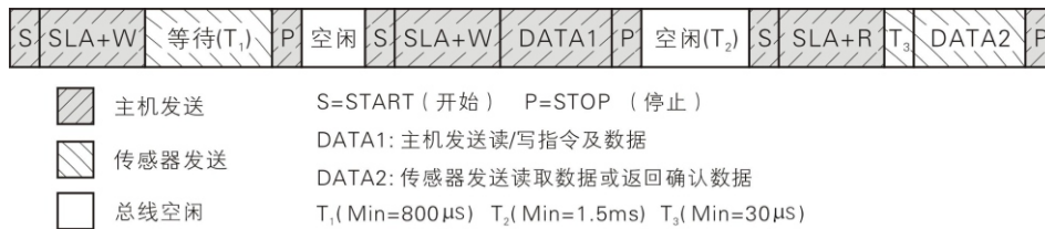
图 14: I 2 C 读写传感器完整示例图
