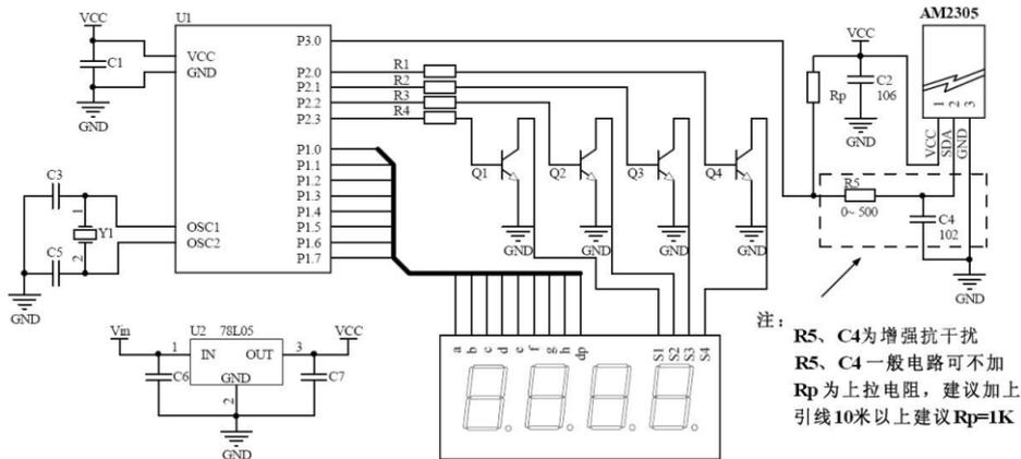
图 4：AM2305 单总线典型电路
