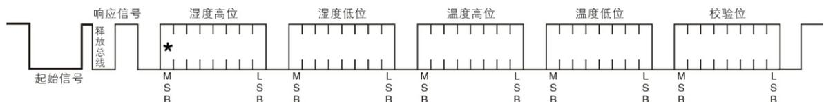
图 5：AM2305 单总线通信协议
