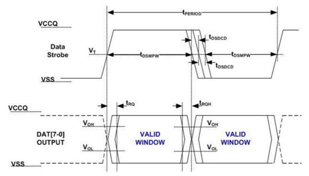
Note :  $V_{\text{OH}}$  denotes  $V_{\text{OH}}(\text{min})$  and  $V_{\text{OL}}\text{denotes}$   $V_{\text{OL}}(\text{max})$
