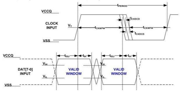
Note :  $V_{IH}$  denote  $V_{IH}(min)$  and  $V_{IL}$  denotes  $V_{IL}(max)$
