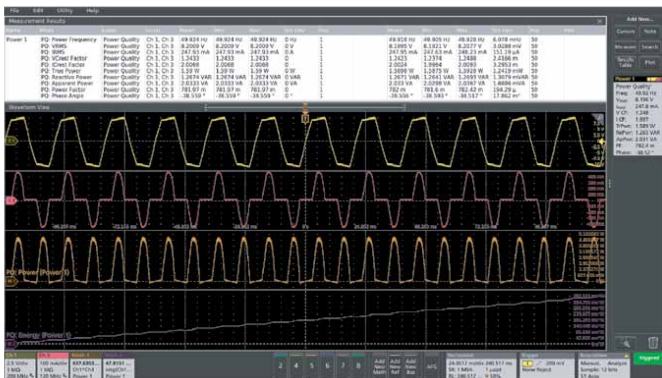
图 5. 功率质量测量绘制了丰富的 AC 线路图画。工频电压是上方波形，电流是红色波形，瞬时功率是橙色波形。结果标签（右上方）显示了工频特点摘要，上方区域的结果表可以激活，提供更详细的数据和统计信息。
