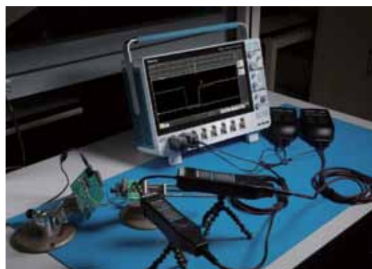
图 4. 许多电源拓扑要求在存在大的共模信号时测量小的差分电压。例如，半桥开关阶段高侧的 V_{GS} 和 V_{DS} 通常会相对于地电平上下移动几百或几千伏的电压。IsoVu™ 隔离测量系统可以与 5 系列 MSO 结合使用，提供超高共模抑制功能。
