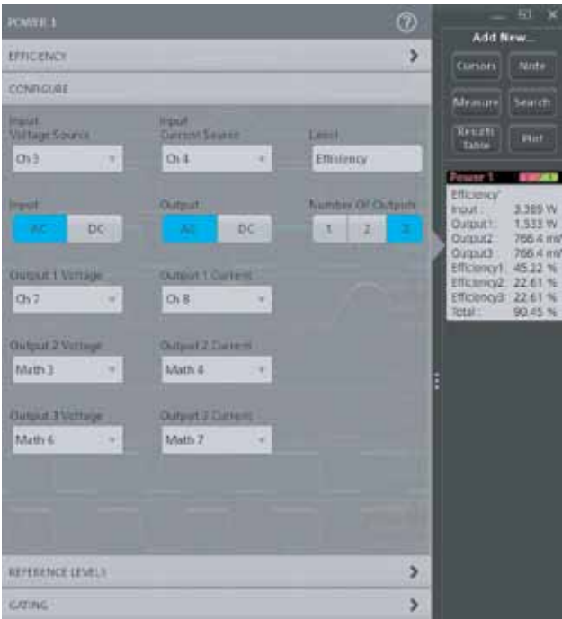
图 18. 效率测量配置允许用户配置信号类型及最多 3 个输出。
