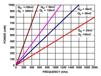
FIGURE 6. POWER DISSIPATION vs FREQUENCY
