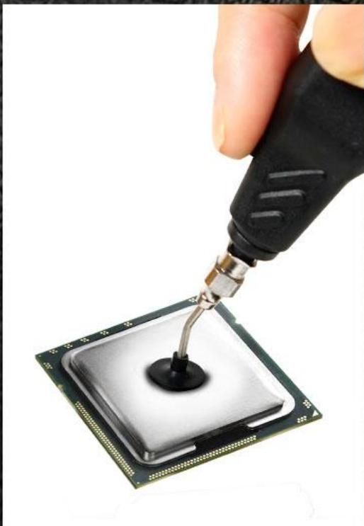
吸笔直接从料带拿料，避免了对元器件拾取不当造成的损坏，使贴片效率更高，避免出现锡珠，使贴片效率更高，避免出现锡珠，焊桥等现象
