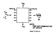
Fig. 13 - Input-voltage test circuit.
