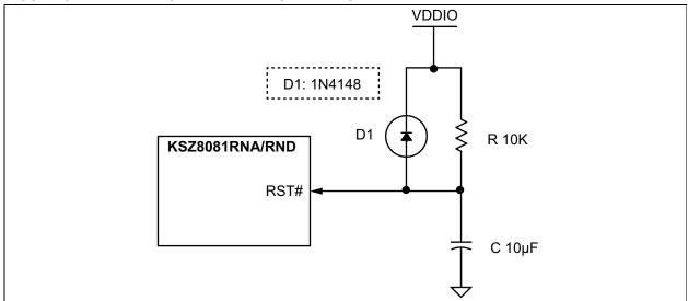
FIGURE 8-1: RECOMMENDED RESET CIRCUIT
