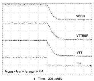
Figure 30. Soft-Start Waveforms Tracking Discharge
