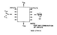
Fig. 12 - Input-voltage test circuit.
