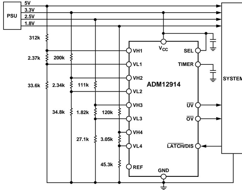
图23. 典型应用图：监控5 V、3.3 V、2.5 V和1.8 V，1.5%电源容差和5%输入容差要求
