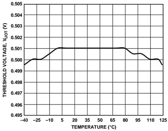
图4. 输入阈值电压与温度的关系
