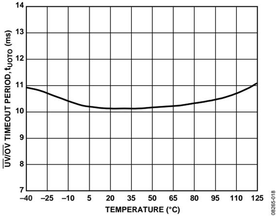
图10.  $\overline{UV/OV}$  超时时间与温度的关系
