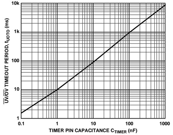
图15.  $\overline{UV/OV}$  超时时间与电容的关系
