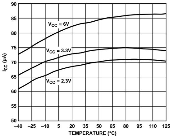
图5. 电源电流与温度的关系
