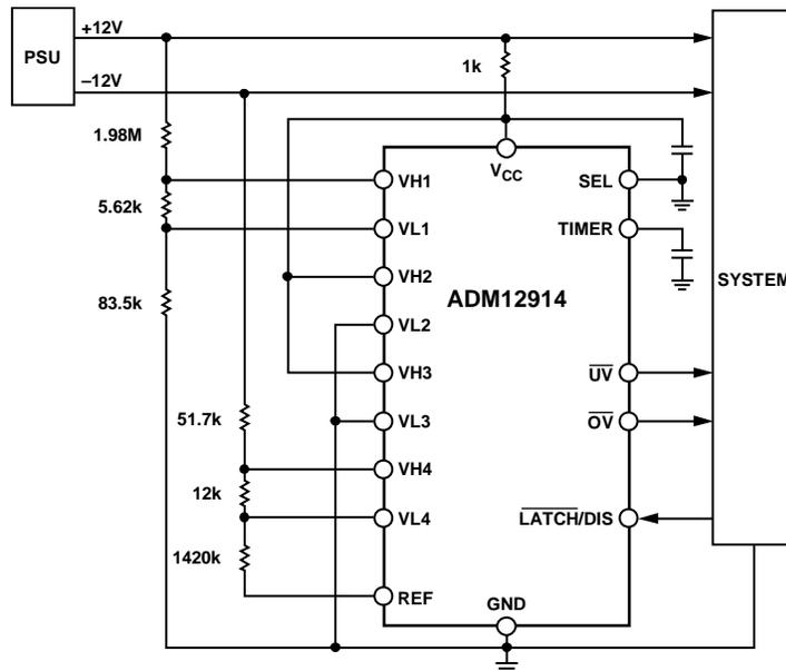
图24. 典型应用图：监控12 V，1.5%电源容差和5%输入容差要求；
