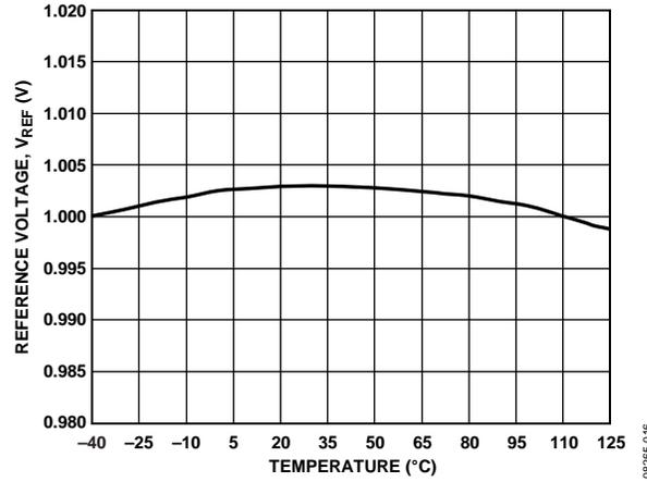
图8. 经缓冲的基准电压与温度的关系
