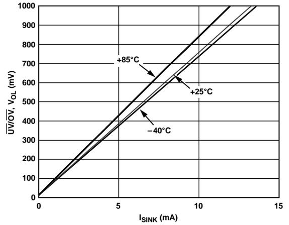
图14.  $\overline{UV/OV}$  低电平输出电压与输出吸电流的关系
