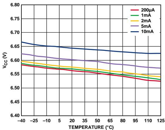
图6.  $V_{CC}$  并联稳压器与温度的关系
