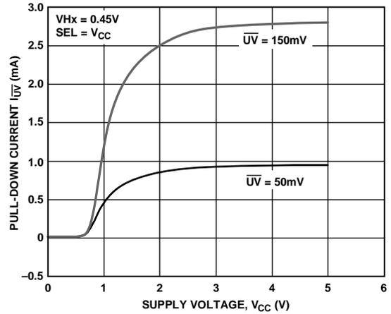
图13.  $I_{SINK}$ 、 $I_{UV}$  与  $V_{CC}$  的关系
