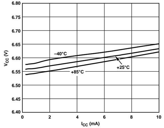
图7.  $V_{CC}$ 分流电压与  $I_{CC}$  的关系
