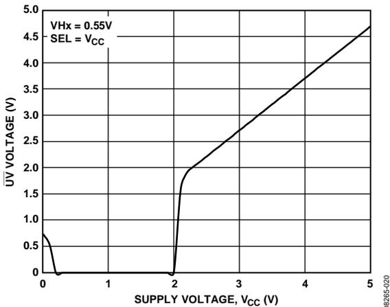
图12. 输出电压与  $V_{CC}$  的关系
