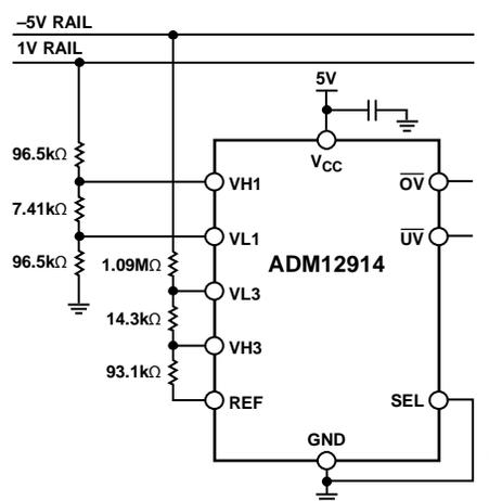
图20. 正负电源监控示例
