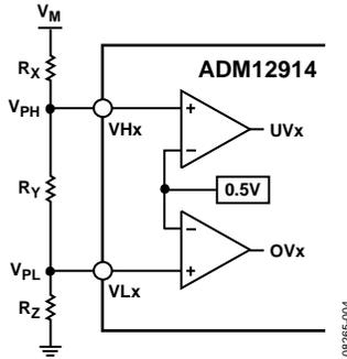
图17. 正欠压/过压监控配置
