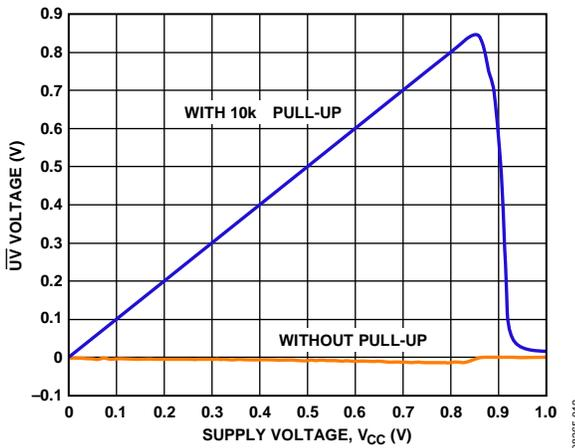
图11.  $\overline{UV}$  输出电压与  $V_{CC}$  的关系
