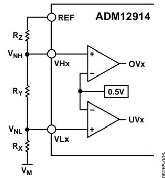
图18. 负欠压/过压监控配置
