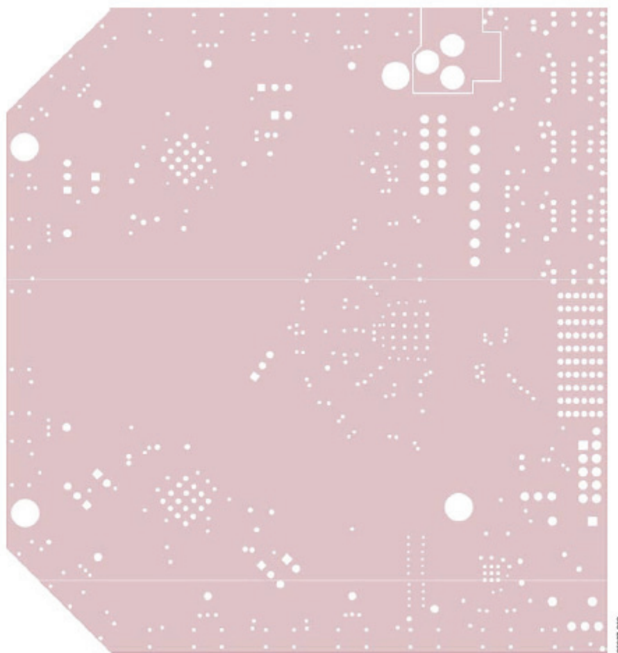
图 98. 评估板布局布线——接地层
