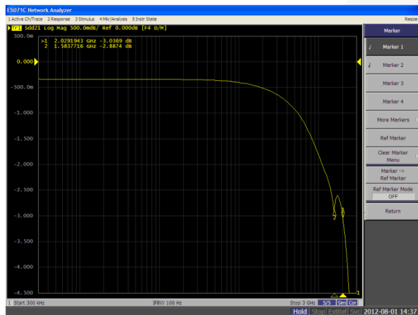
图 17. MHL 路径 SDD21 插入损耗曲线
