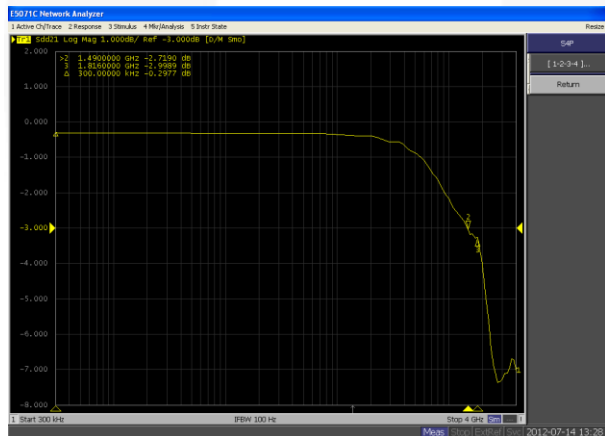
图 18. USB 路径 SDD21 插入损耗曲线
