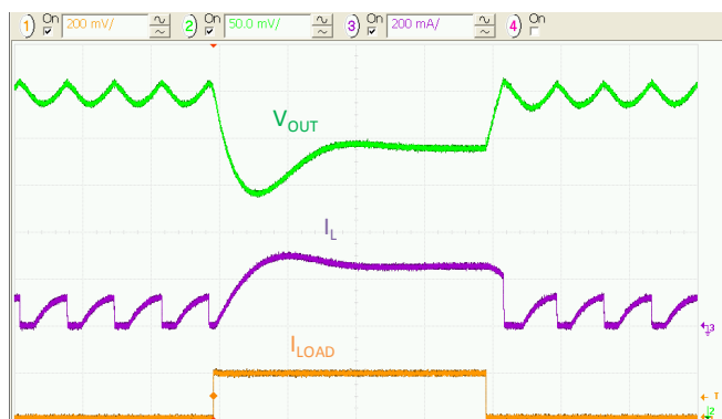
图23. 负载瞬态, 50 mA 至250 mA, V_{IN}=3V , t_{RISE}=t_{FALL}=100ns , 5\mu s/div 。
