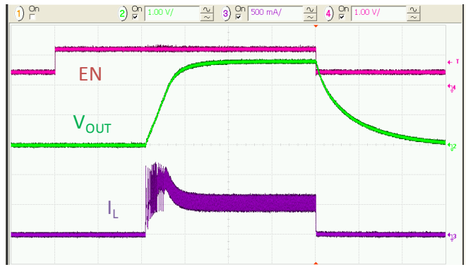
图18. 500 mA 负载, 50 \mu s /div, 启动和关断 V_{EN}
