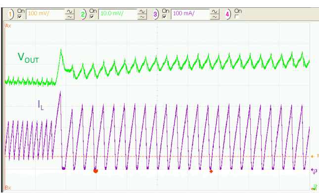
图14. V_{IN}=3.6\text{V} , 2\mu\text{s/div} , PWM转换至PFM
