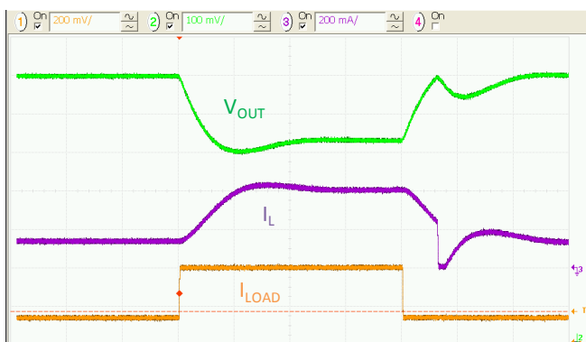
图24. 负载瞬态, 150 mA至400 mA, V_{IN}=3V , t_{RISE}=t_{FALL}=100ns , 5\mu s/div 。
