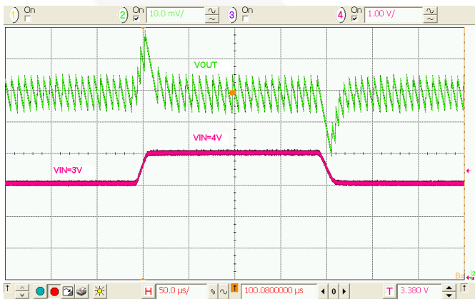
图 20. 线路瞬态， 50\ \Omega Load, t_R=t_F=10\ \mu\text{s}
