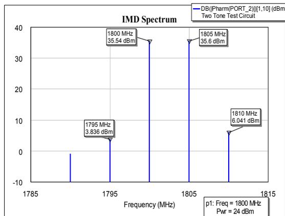
Figure 4: Intermodulation Spectrum ( $P_{IN}=24$  dBm)
