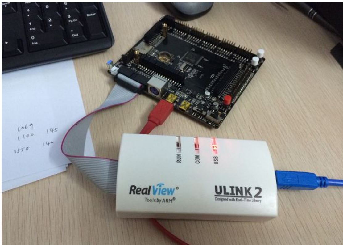
ULINK2 与 MINI 连接，USB 线都连接电脑，使用时记得把开发板电源开关打开。
