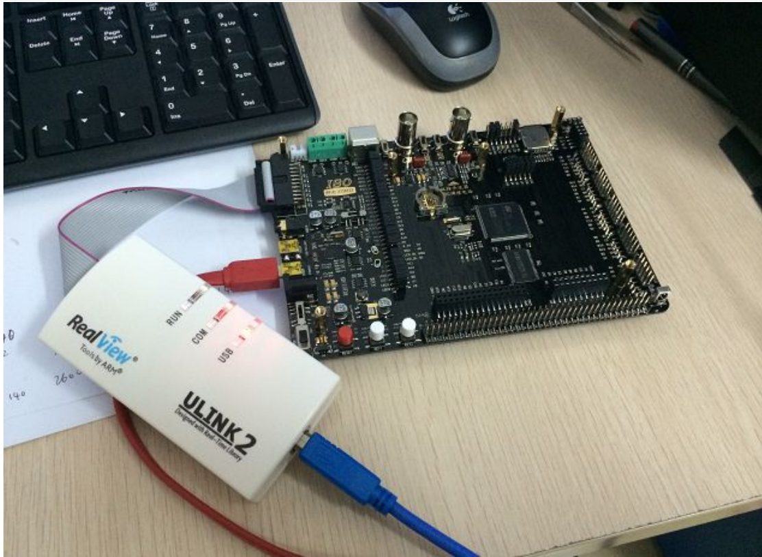
ULINK2 与 ISO 连接，USB 线都连接电脑，使用时记得把开发板电源开关打开。
