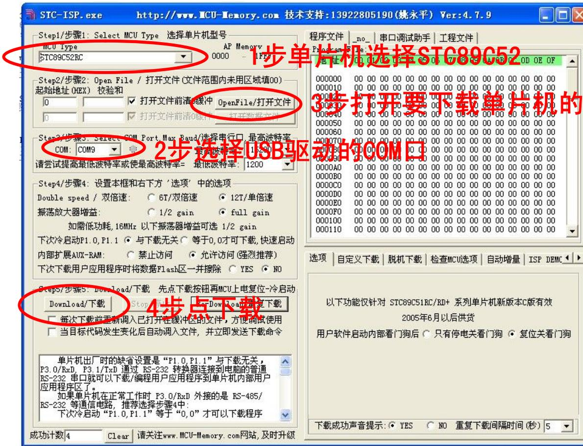
STC单片机下载方法为冷下载.即下载前单片机实验板的开关的弹上来的(关机状态),操作了第4步以后等一秒钟再按下单片机的开关就可以了.
