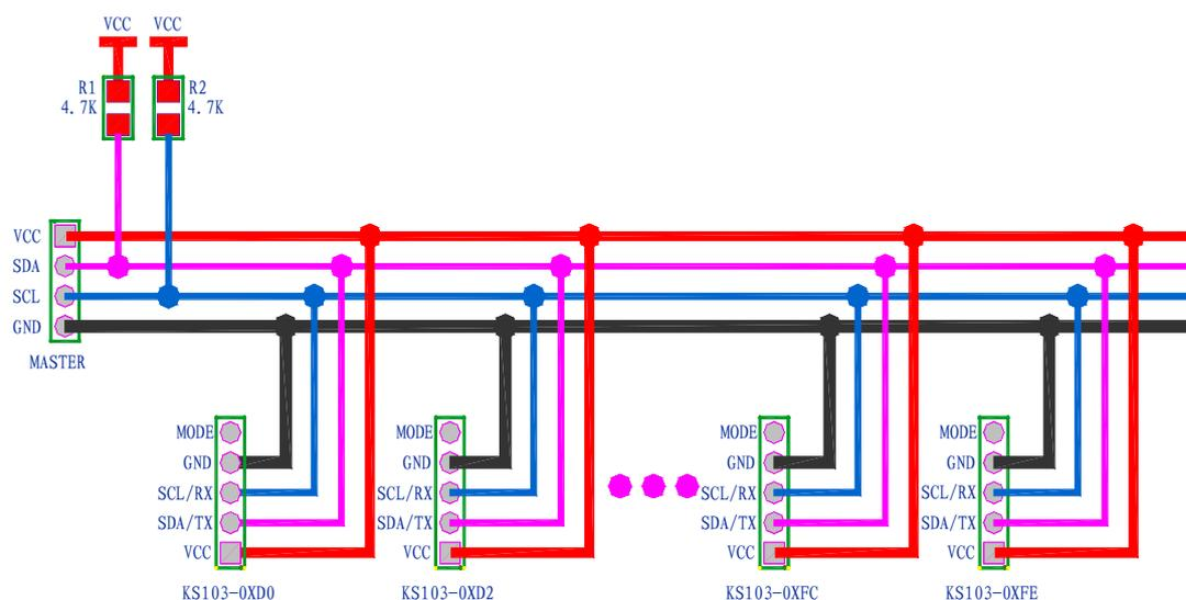
KS101B/KS103/KS103S 默认地址为 0xe8, 用户可以将地址修改为 20 种地址中的任何一个: 0xd0, 0xd2, 0xd4, 0xd6, 0xd8, 0xda, 0xdc, 0xde, 0xe0, 0xe2, 0xe4, 0xe6, 0xe8, 0xea, 0xec, 0xee, 0xf8, 0xfa, 0xfc, 0xfe.<sup>(2)</sup>
