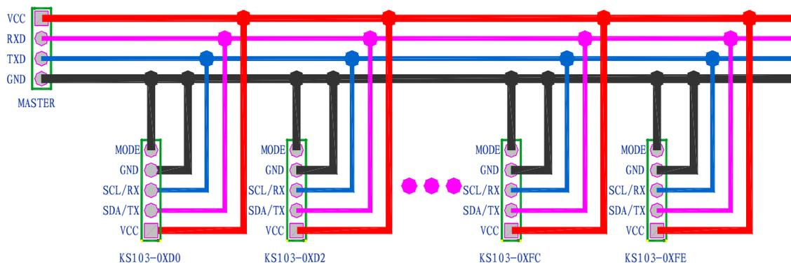
KS101B/KS103/KS103S 默认串口地址为 0xe8, 用户可以将地址修改为 20 种地址中的任何一个: 0xd0, 0xd2, 0xd4, 0xd6, 0xd8, 0xda, 0xdc, 0xde, 0xe0, 0xe2, 0xe4, 0xe6, 0xe8, 0xea, 0xec, 0xee, 0xf8, 0xfa, 0xfc, 0xfe. <sup>(2)</sup>
