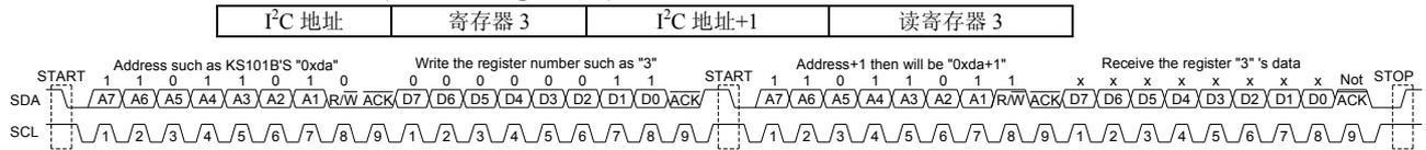
Note 5: 采用读任意寄存器指令时, 如果读寄存器 2 及寄存器 3, 必须先发送针对寄存器 2 的探测指令。注意, 所有探测指令都储存在寄存器 2 中。例程中采用了先 发送探测指令 再 读任意寄存器指令时序(读寄存器 2+ 读寄存器 3)。向 KS103 写入 “I<sup>2</sup>C 地址+1” 后, 不能立即去接收 8bit 的数据, 要等待 ACK 低电平的有效回应, 或再延时至少 4.7us, 才可以接收到寄存器的数据。在写 “I<sup>2</sup>C 地址+1” 与 “读寄存器 2/3” 之间加一个至少 4.7us 延时的话, I<sup>2</sup>C 通信速率可以调大仍可以与 KS103 可靠通信。
