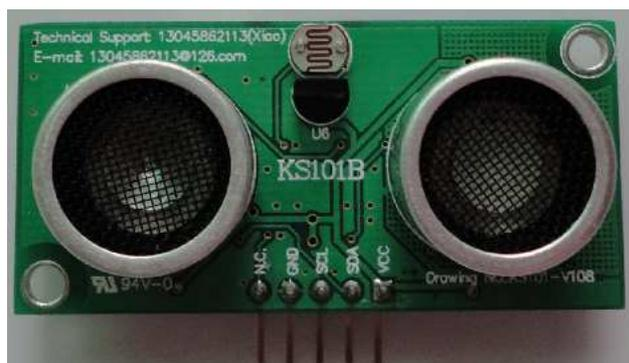
在 KS101B/KS103/KS103S 上连线引脚上标识有：VCC、SDA/TX(简称 SDA)、SCL/RX(简称 SCL)、GND 及 MODE。MODE 引脚悬空时，KS101B/KS103/KS103S 工作于 I<sup>2</sup>C 模式。
