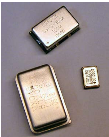
图7 典型低成本CMOS时钟振荡器
