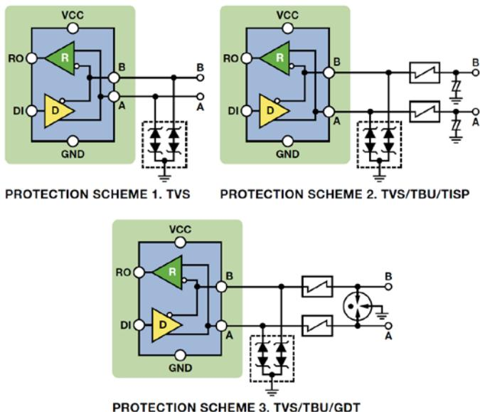
图 6. 三个 EMC 兼容 ADM3485E 电路
