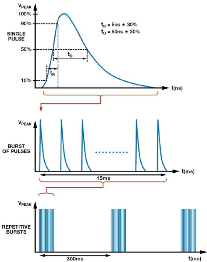
图 2. IEC 61000-4-4 EFT  $50 \Omega$  负载波形
