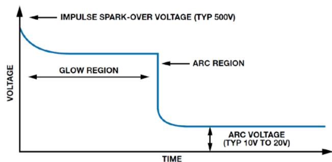
图 9. GDT 特性波形
