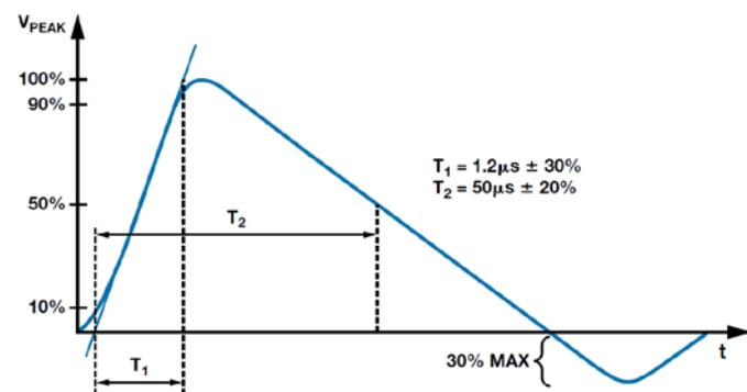
图 3. IEC 61000-4-5 电涌  $1.2/50 \mu s$  波形
