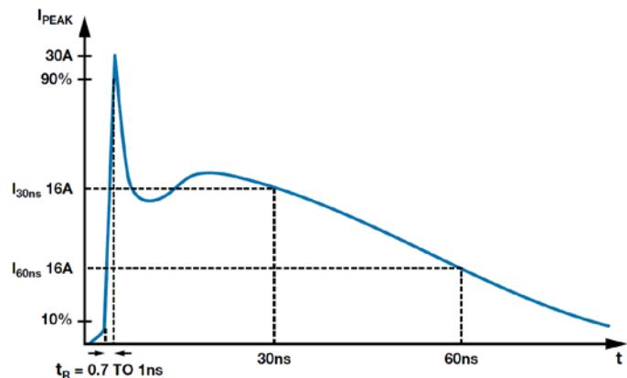
图 1. IEC 61000-4-2 ESD 波形 (8 kV)
