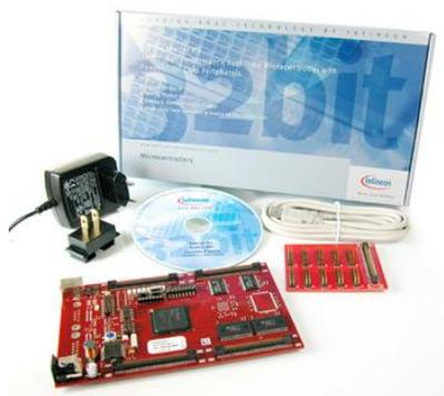
图 1（见右图） Tricore 评估板实物参照图
