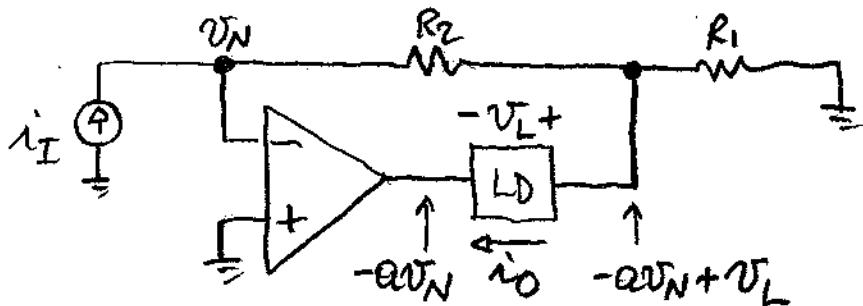
$$\text{D: } V_N - (-aV_N + V_L) = R_2 i_I$$
