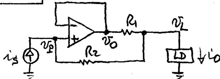
$$V_p = V_L + R_2 i_S; V_0 = a(V_p - V_L) \Rightarrow V_0 = \frac{a}{1+a} V_p$$
