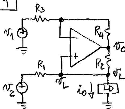
$$\text{Superposition: } V_O = -\frac{R_4}{R_3} V_1 + \left(1 + \frac{R_4}{R_3}\right) V_L ; \text{ KCL:}$$
