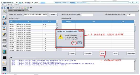
选择 YES 之后,程序开始下载,下载完成后,下方提示相关信息,并将前 32K 的数据读取出来。如果前 32K 有数据,或者前面烧写过程序,则需要先点击 Erase 进行擦除,如下图 ftm.
