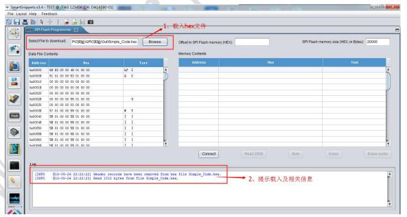
在 Offset in Flash memory(HEX)处使用默认不输入,在 Flash memory size(HEX,in Bytes)输入 FALSH 的大小,之后点击 Connect 进行连接,下方会提示下载固件成功,表示连接正常,之后 Read 32KB、Burn、Erase、Erase Sector 按钮可用,如下图所示:
