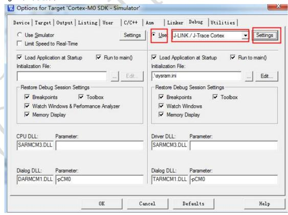
点击 Settings 之后弹出的对话框中,选择 SW,插入与开发板正确连接的 Jlink 之后,
