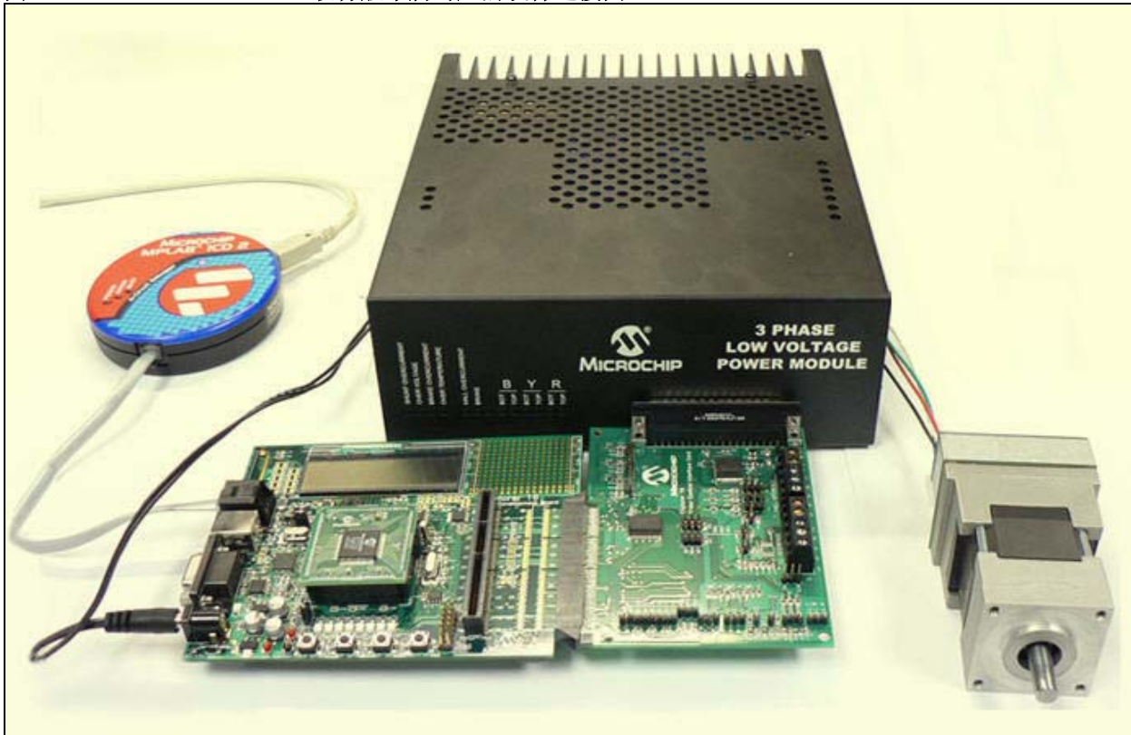
图 9: dsPIC33F 软件版本所对应的硬件连接图
