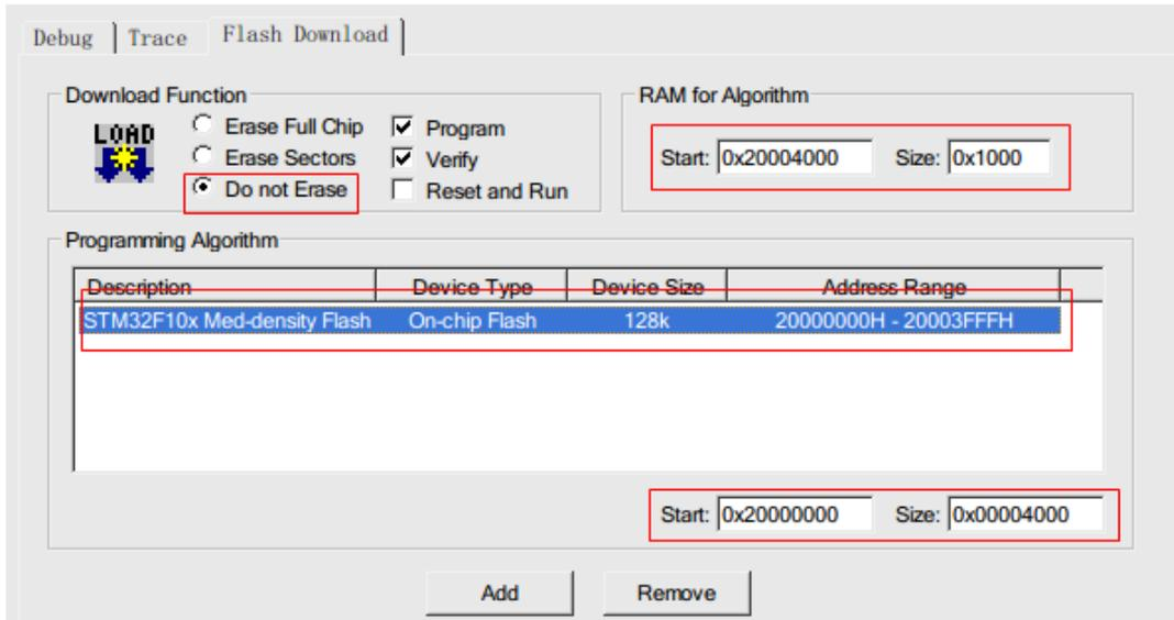
8、如下图所示, 在选项设置对话框中 Utilities 中, Use Target Driver for Flash Programming 中选择 Cortex-M3 J-LINK, 并点击 setting 进一步设置,
