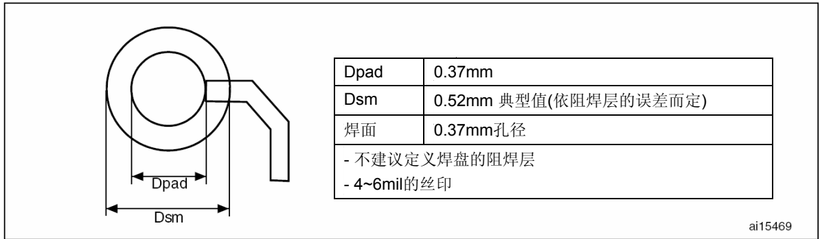
图60 建议的PCB设计规则(0.5mm间距的BGA封装)
