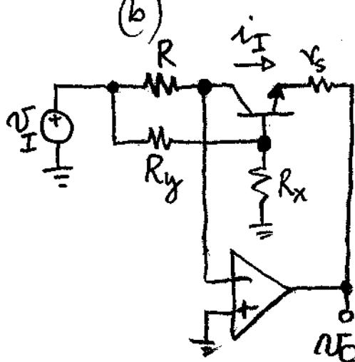
$$V_o = V_B - V_{BE} - r_s i_I$$
