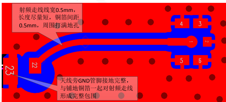
图 3-25 射频走线示意图
