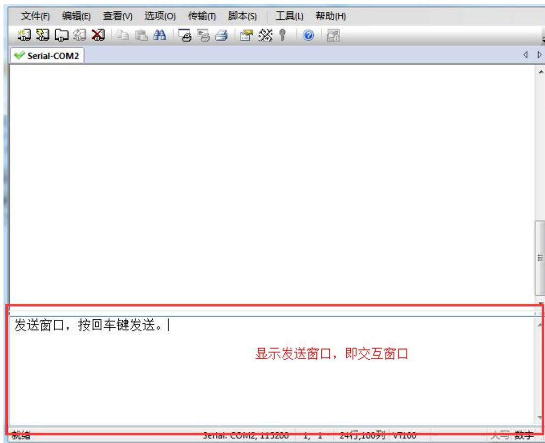
如果要在接收串口中显示自己发送的字符，进行如下设置，如下图所示：
